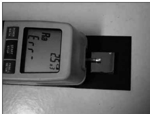
Figura 4. Ensaio e a determinação dos parâmetros de Rugosidade – Ra [ \mu\text{m} ]
