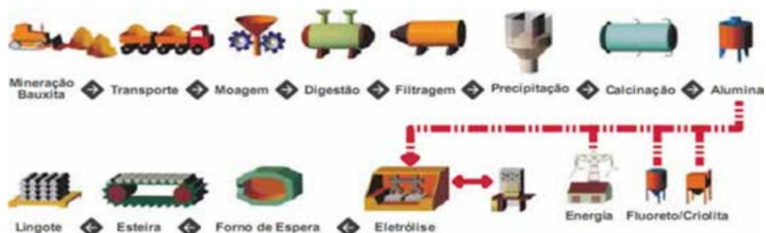
Figura 2- Processo de obtenção do alumínio
