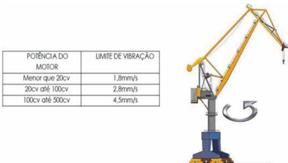
Figura 6: Limites de vibração para motores elétricos
