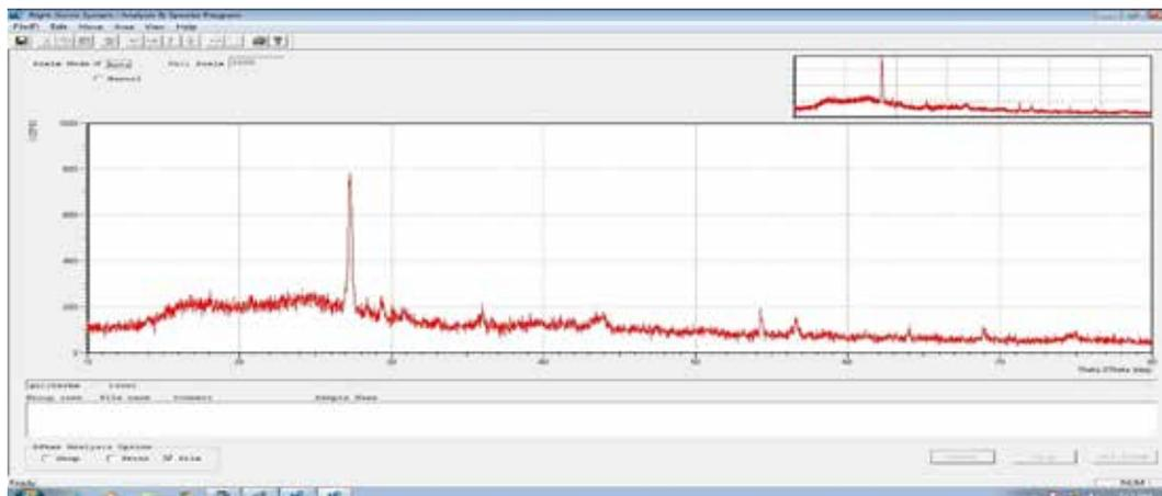
Os picos de difração presentes na Figura 4 correspondem a fase Fe, indicando que os outros componentes do aço inox encontram-se em solução sólida.
