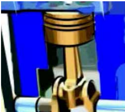
Figura 11. Pistão do compressor de pistão Fonte: Bosch, 2008.
