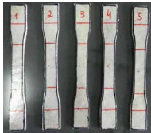
Figura 6. Corpos de prova do material proposto para o ensaio de tração.
