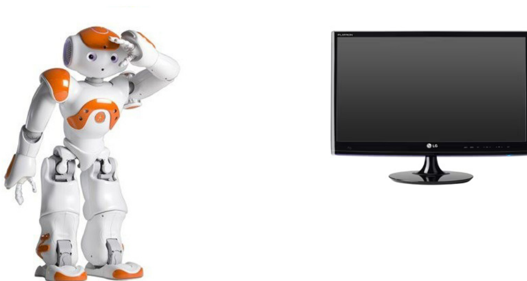
Figura 3 - Configuração experimental com o robô NAO posicionado em frente a uma tela exibindo placas veiculares para processamento por OCR
