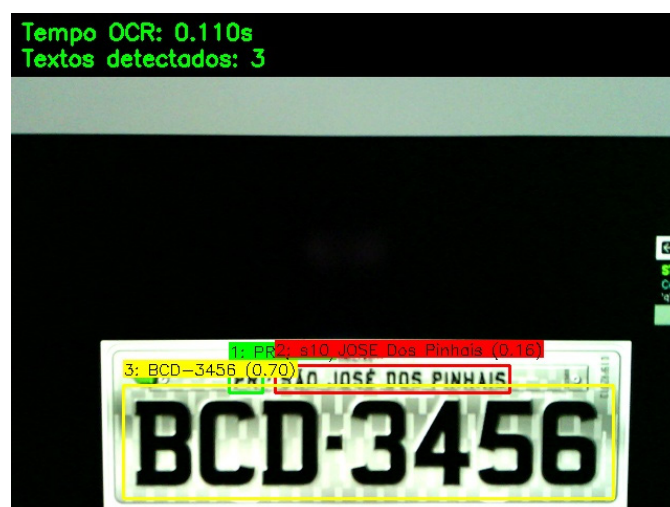
Figura 7 - Detecção da placa "BCD-3456" com três elementos textuais, com nome da cidade reconhecido parcialmente
