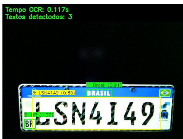
Figura 5 - Reconhecimento da placa "LSN4I49" com três elementos textuais. As caixas delimitadoras indicam as regiões detectadas
