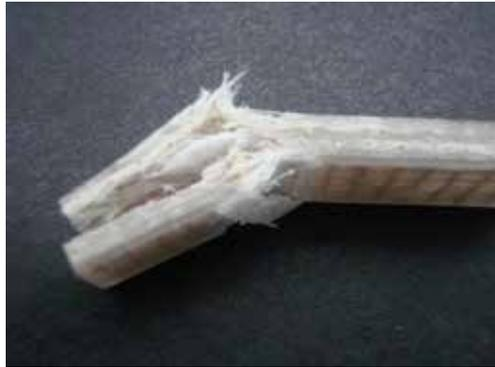
Figura 9. Fratura dos laminados após o ensaio de impacto.
