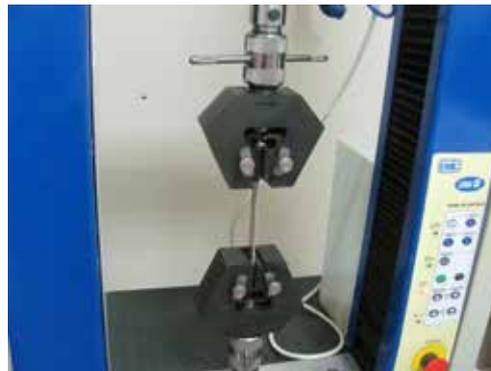
Figura 5. Máquina EMIC para o ensaio de tração
