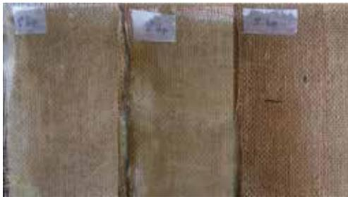
Figura 2. 1ª Hipo: laminado (FV/FJ/FV/FJ/FV/FJ/FV); 2ª Hipo: laminado (FV/FV/FJ/FJ/FV/FV/FV); 3ª Hipo: laminado (FJ/FJ/FV/FV/FV/FJ/FJ).
