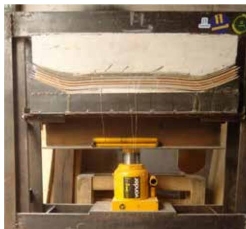
Figura 1. Processo de compressão para obtenção do compósito.
