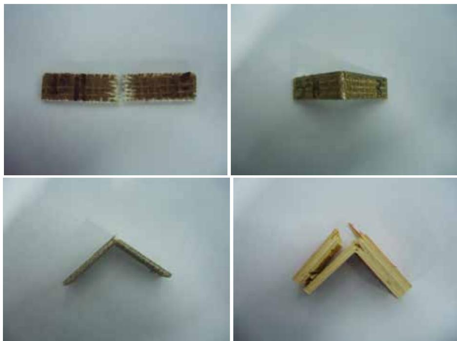
Figura 4. Fratura dos laminados após o ensaio de impacto.
