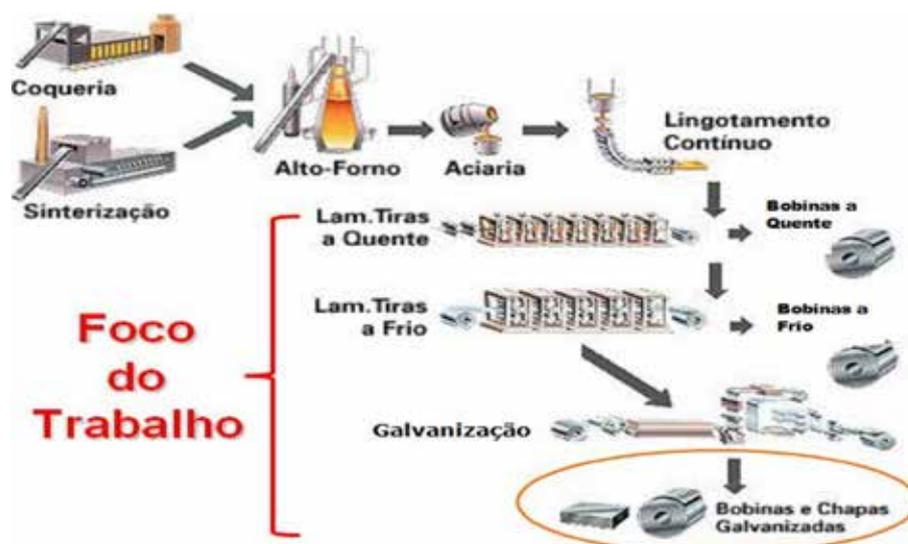
Figura 4 – Fluxo de fabricação de aço
