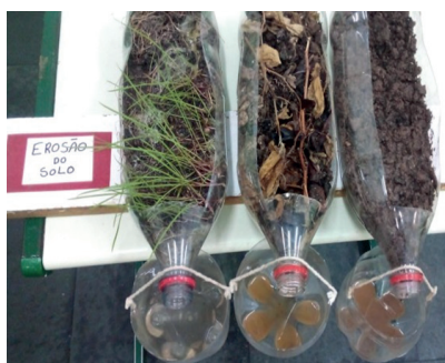
Figura 1: Montagem do experimento do processo de assoreamento.
